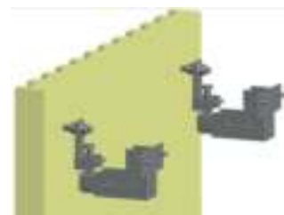
КРЕПЛЕНИЕ БОЛЬШЕ- ФОРМАТНЫХ ПЛИТ
